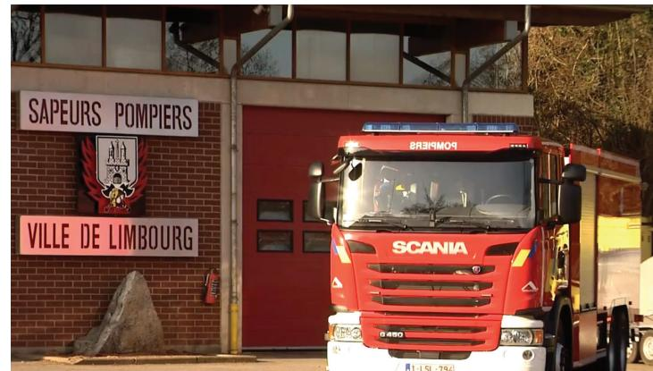
Le véhicule, de 26 tonnes et 450 chevaux, représente un investissement de 291.046 euros à charge de la Zone. Il est utilisé en tant que citerne traditionnelle au poste de Limbourg, mais également en tant que véhicule de renfort spécialisé pour les incendies importants au sein de la Zone ou en dehors (déclenchement automatique pour les incendies d'industries notamment).
